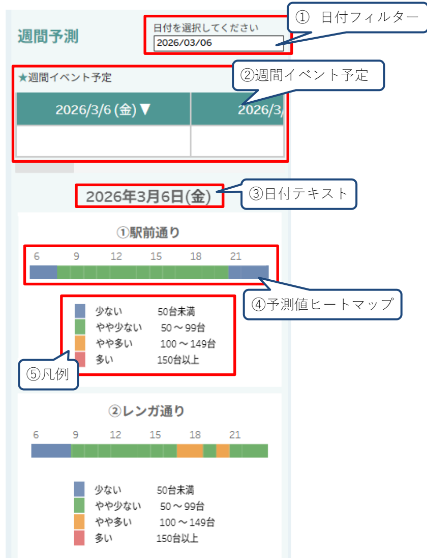
図 13 交通予測画面：週間予測エリアのスマートフォンレイアウト
